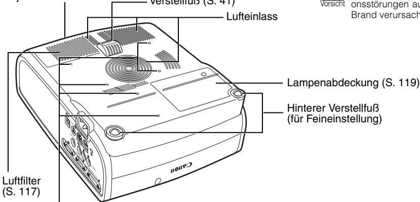
Schraubenbohrungen zum Anbringen der Halterung
