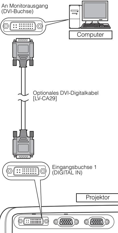
Eingangssignal: Wählen Sie [Digital PC] oder [Analog PC-1] aus (S. 46).
