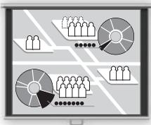
Wählen Sie diesen Modus aus, um ein breites Bild oder Computerbild mit einem Bildseitenverhältnis von 5:4 (SXGA) zu projizieren.
