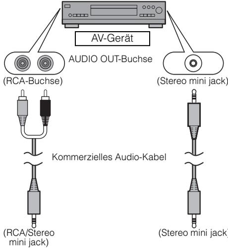
Sie können ein Audiosignal empfangen, das 3 Bildeingangssystemen entspricht. Schließen Sie es an die AUDIO IN-Buchse an, die der Art des Bildeingangssignals entspricht.
