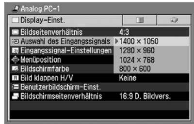
Wählen Sie aus den angezeigten Signalarten die Signalart aus, die für den Computer geeignet ist. Drücken Sie abschließend die [MENU]-Taste.
