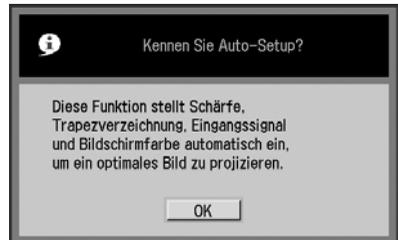
Das Countdown-Fenster wird für rund 20 Sekunden angezeigt. Anschließend erscheint eine Meldung zur Verwendung der Auto-Setup-Funktion. Stellen Sie die Schärfe mit der Auto Setup-Funktion oder der Schärfereinstellung ein, wenn Sie die Meldung nicht lesen können, weil sie unscharf ist (S. 44, 49). Die LED-Anzeigelampe blinkt blau, bis mit der Projektion begonnen wird. Drücken Sie die [OK]-Taste, um sofort mit der Projektion zu beginnen.
